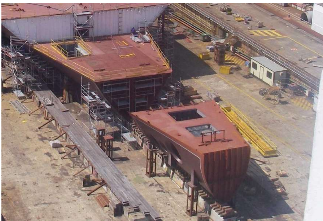
Ensamblaje de bloques en grada (Imagen facilitada por el autor)
