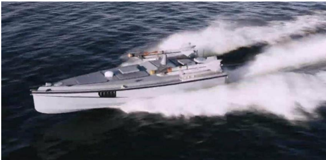
Magura V7, de fabricación ucraniana, equipado con misiles aire-aire (Sidewinder) adaptados (foto ejército ucraniano)
