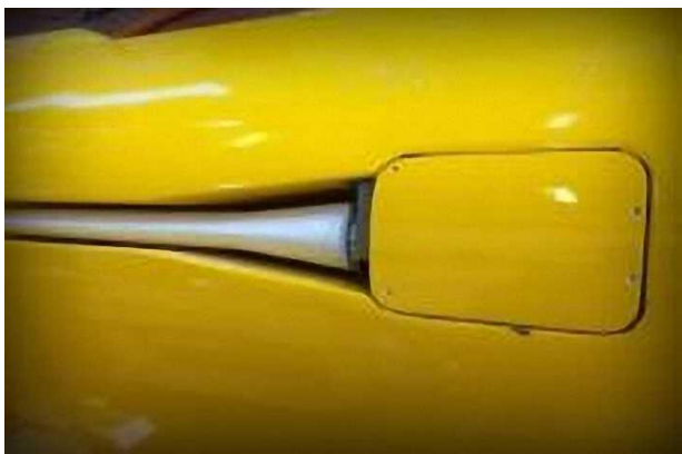
Figura 3: Aleta estabilizadora retráctil con escotilla de cierre
