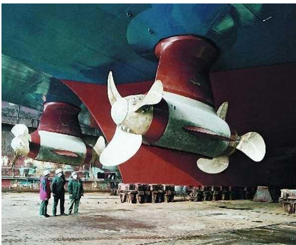
Figura 2: Palas de hélices tipo "POD" del BPE Juan Carlos I
