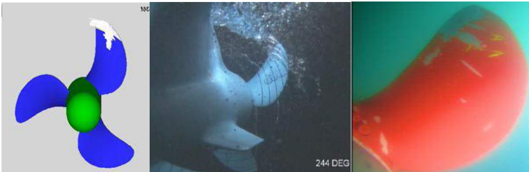
Fig. 6 Comparación entre la predicción numérica (Izquierda) y experimental (Centro) con la erosión real del antifouling de la pala de un buque en servicio
